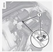
Sluit de positieve kabel *A* op de **steun 1** op de **pluspool 2** (+) van de ontladen accu aan en daarna op de **pluspool 3** (+) van de hulpaccu.
