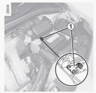
Sluit de positieve kabel  ${\it A}$  op de  ${\it steun 1}$  op de **pluspool 2** (+) van de ontladen accu aan en daarna op de **pluspool 3** (+) van de hulp-
